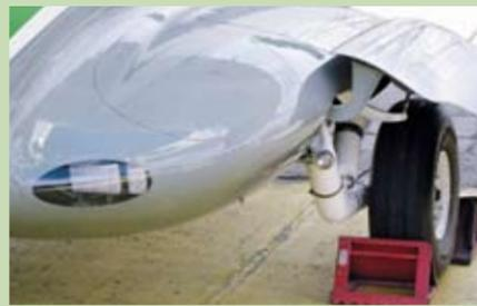
**FEINE SACHE:** Das robuste breite Fahrwerk ist geschleppt angelegt. Die Roll- und Landescheinwerfer setzen auf LED-Technologie.
