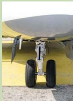
**LENKHILFE:** Die Rollsteuerung am Boden wird hydraulisch unterstützt. Das Doppelrad wäre sonst wohl kaum zum Einlenken zu bewegen.
