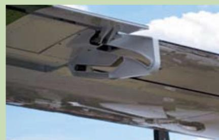
**AUFWÄNDIG:** In einem STOL-Flugzeug kommt den Auftriebshilfen besondere Wichtigkeit zu. Die EV-55 darf sich auf Fowlerklappen verlassen.
