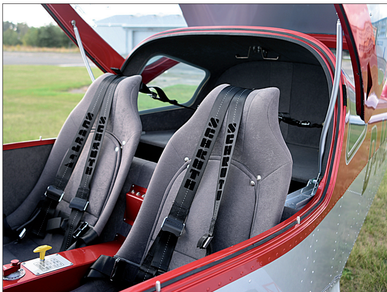
Weit hochgezogene Rückenlehnen bieten guten Komfort. Die Cockpitbreite mit 118 cm ist ausreichend, die Headsethalterung ist sehr praktisch und durchaus kein Standard.
