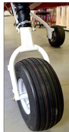
Das Bugrad macht einen soliden Eindruck und ist dank der „Bungee“-Aufhängung auch schulungstauglich (Foto rechts)..
