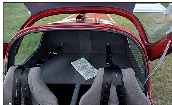
Das Gepäckabteil kann man mit 15 kg beladen. Praktisch sind die beiden Mulden, allerdings sollte im hinteren Bereich wegen weight & balance nur leichtes Gepäck verstaut werden.
