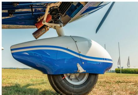
**Optimiert** Federung und Dämpfung des gelenkten Bugrads wurden verbessert
