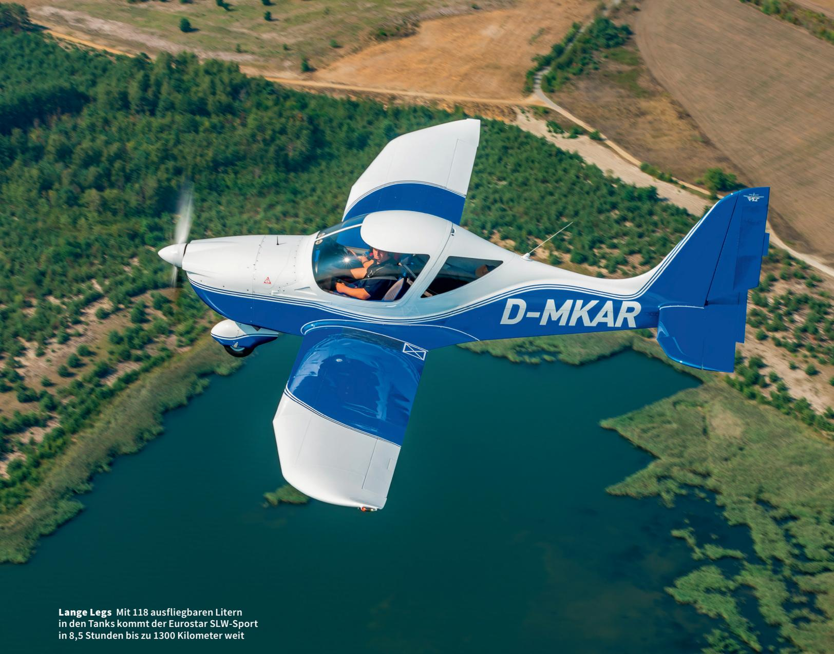
**Lange Legs** Mit 118 ausfliegbaren Litern in den Tanks kommt der Eurostar SLW-Sport in 8,5 Stunden bis zu 1300 Kilometer weit
