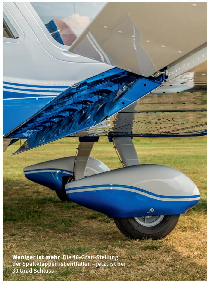
**Weniger ist mehr** Die 48-Grad-Stellung der Spaltklappen ist entfallen – jetzt ist bei 30 Grad Schluss
