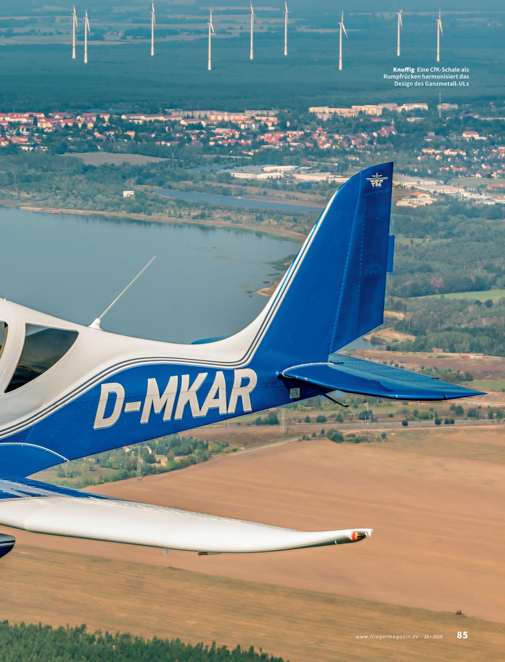
**Knuffig** Eine CfK-Schale als Rumpfrücken harmonisiert das Design des Ganzmetall-ULs
