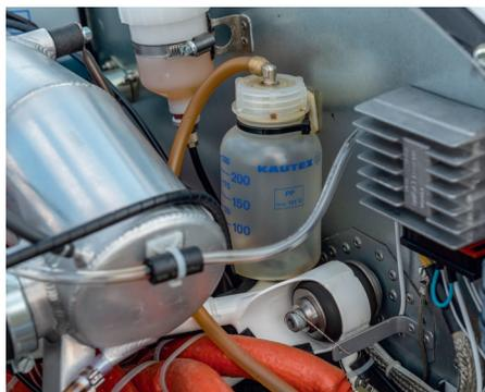
**Sauber** Öldämpfe aus dem Motor landen nicht einfach auf der Rumpfunterseite – sie sammeln sich in einem Behälter, der regelmäßig geleert wird
