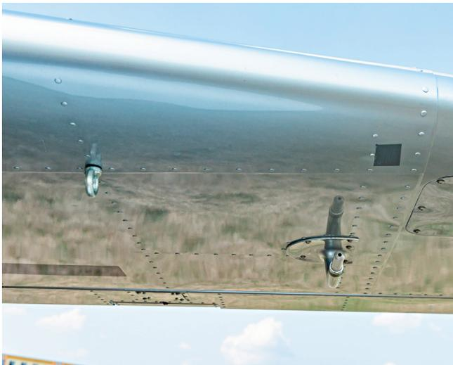
**Ungestört** Früher war die Verzurröse vor dem Staurohr angebracht – und führte durch Verwirbelungen zu Fehlanzeigen
