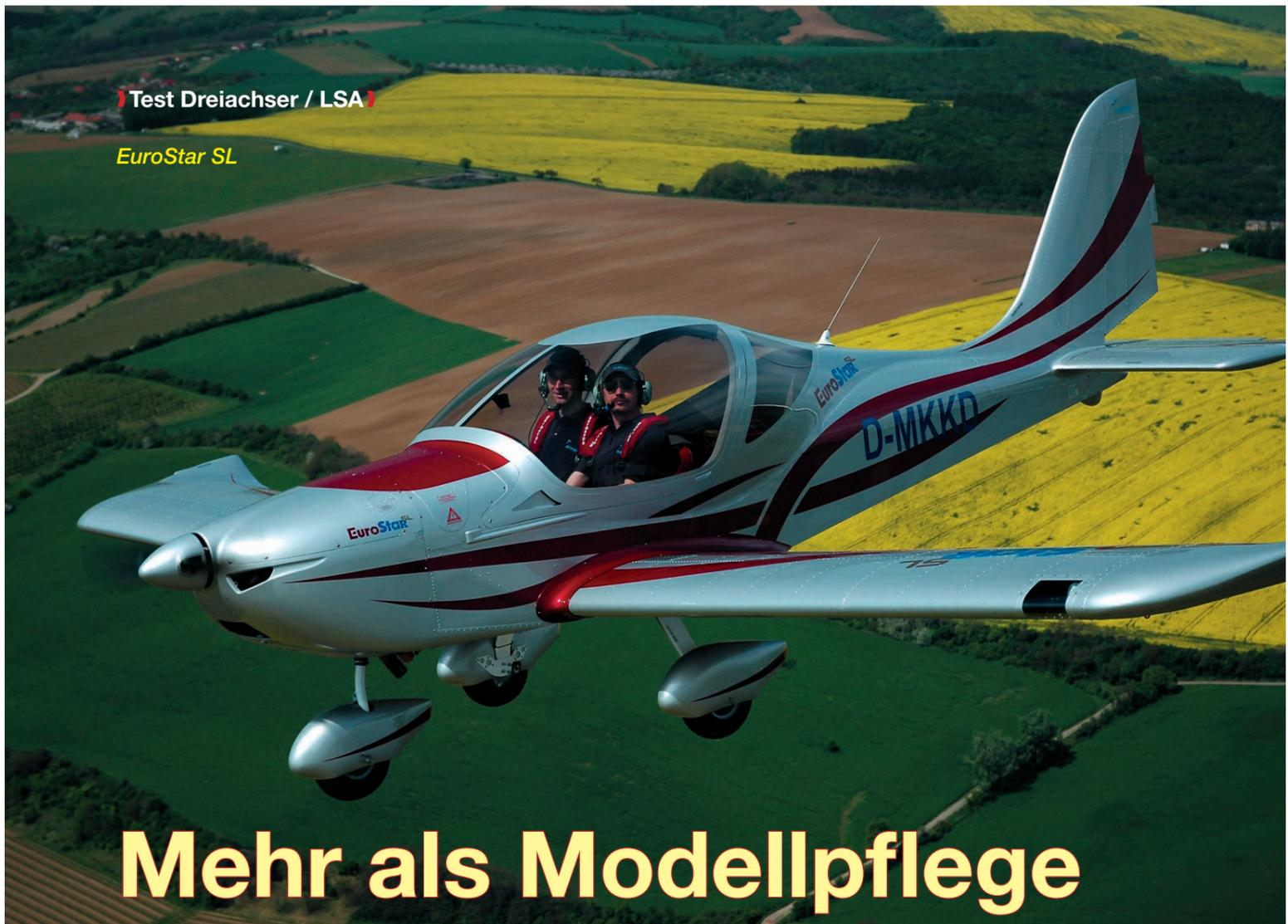
Seit 1997 wird der EuroStar von der Firma Evezor gefertigt. Das Erfolgsmodell aus Tschechien wurde bisher über 800 mal als UL und LSA aus den Werkshallen von Kunovice gerollt. Es ist ein klassischer Metalltieflieger mit Rechteckflügeln, bestückt mit Rotax-Triebwerken. Mit dem neuen EuroStar SL ist nun die bislang umfassendste Überarbeitung des Erfolgsmodells auf den Markt gekommen – ein echt neues Flugzeug, weit mehr als einfach nur Modellpflege.
